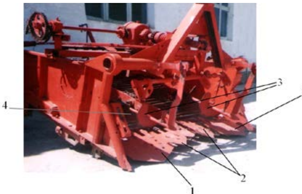
1- основные плоские подкапывающие лемеха; 2 - промежуточные лемеха; 3 - транспортирующие шнеки; 4 - сепарирующий рабочий орган Рис.2. Общий вид усовершенствованного картофелекопателя
