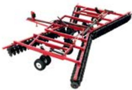
Бороны дисковые тандемные серия DX рабочая ширина захвата 8,8/9,7/10,8 м глубина обработки от 7 до 18 см
