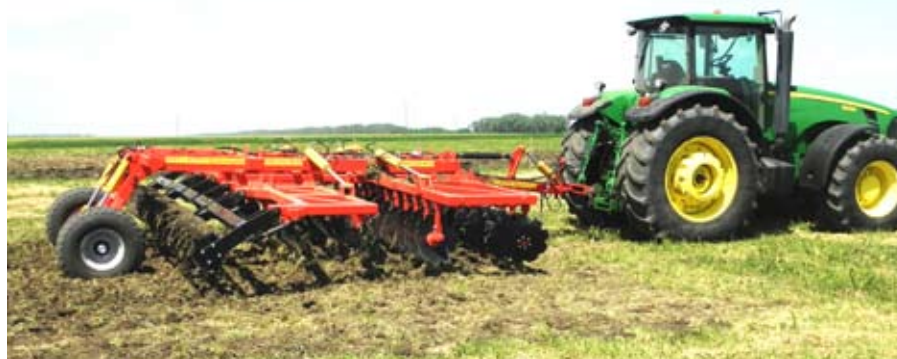
Рис.1. Дискочизель БДЧ-5х4СКПС «Росомаха». Вид справа.
