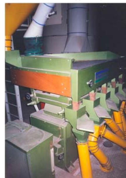
Фото 2. Приемники фракций ПСС КА-1200 фирмы Westrup (Дания), установленный в семяочистительной линии на семенном заводе в Версале (Франция).
