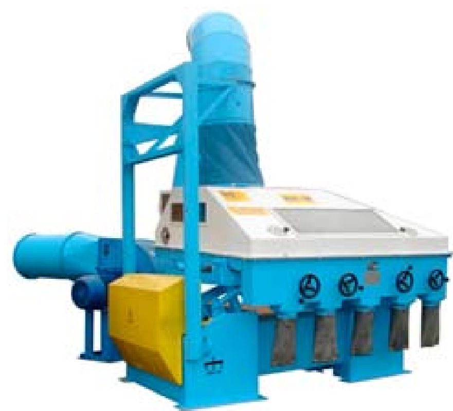
Фото 1. Пневматический сортировальный стол вакуумного типа.
