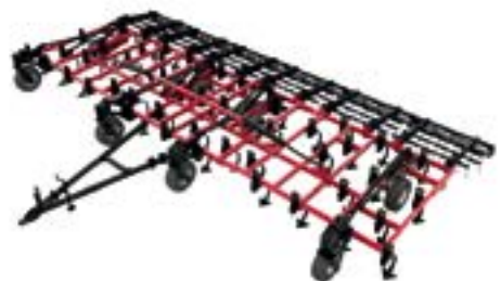
Культиваторы для сплошной обработки серия R рабочая ширина захвата 18,3 м глубина обработки от 5 до 15 см
