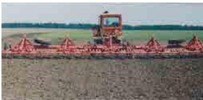
**Фото 7. Культиватор блочно-модульный КБМ-10,5П Нурлатского машзавода. Слева в агрегате с трактором тягового класса 2 МТЗ-1221, справа в агрегате с трактором ДТ-75, который в большинстве случаев работает с культиватором КПС-4 с шириной захвата 4 метра.**
